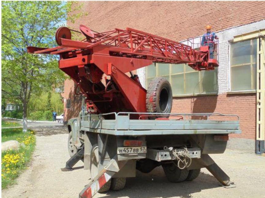
**Использование неисправного автогидроподъёмника в неустойчивом положении (не установлены упоры)**
